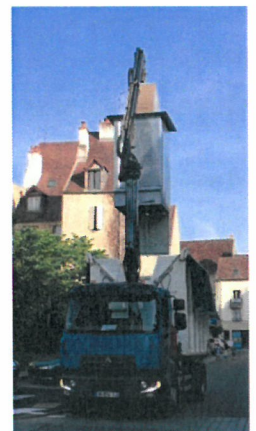
Vidage d'un conteneur enterré
